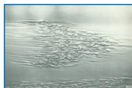
Figure 4.15 Turbulent Spots (NTUU, 2011)
